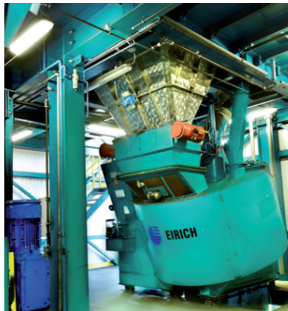
Fot. 6. Mieszarka turbinowa firmy EIRICH zainstalowana w SPM Odlewni Żeliwa FANSULD
