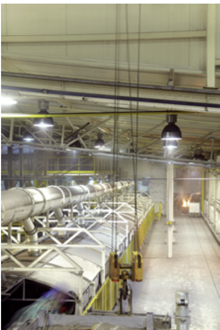
Fot. 10. Linia formowania, formy po zalaniu w tunelu z systemem centralnego odciążu gazów i pyłów technologicznych
