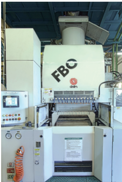
Fot. 8. Formierka FBO V zainstalowana w Odlewni Żeliwa Fansuld - widok z przodu
