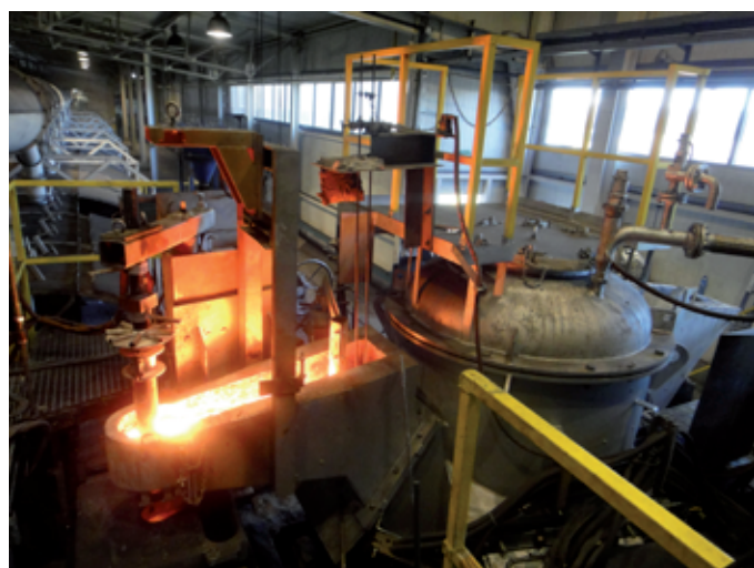
Fot. 3. Urządzenie do automatycznego zalewania form („zalewarka”) firmy OTTO-JUNKER RGD Ge 4/250 na linii formowania
