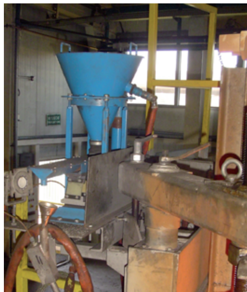
Fot. 4. Dozownik modyfikatora żeliwa dla technologii modyfikacji „na strugę” metalu. Inwestycje w obszarze technologii przerobu mas formierskich
