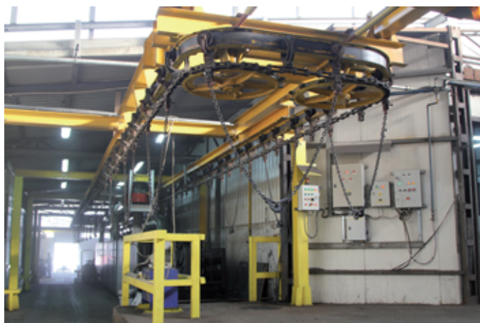
Fot. 12. Autorska, zautomatyzowana linia malowania odlewów drogowych
