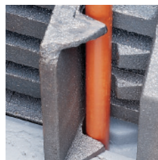
Opatentowane, bezśrubowe mocowanie rusztów
