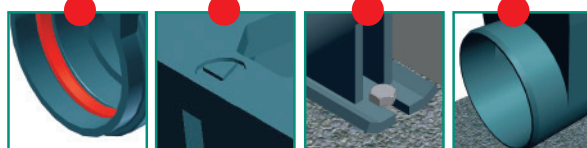
Pierwsze korytko z uszczelką do mufy
